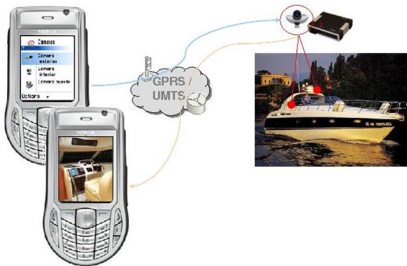
Figura 1. Esquema en el que el Terminal móvil se conecta a la cámara de la embarcación y recibe el vídeo streaming en tiempo real.
